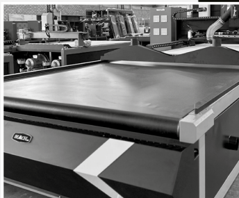
Mesa de Descarga com sensor
